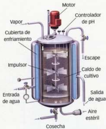
Fermentador industrial. Son depósitos de diferente capacidad en los que existe un medio de cultivo y un sistema de palas o impulsor que mezcla este medio de cultivo con los microorganismos.
