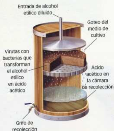
Fermentador de Frings. Es un recipiente de madera relleno de virutas de madera o serrín inoculadas con las bacterias del ácido acético; sobre las virutas va goteando constantemente el medio de cultivo y existe una corriente de aire continuo que las atraviesa. El ácido acético producido se va acumulando en el fondo del fermentador.
